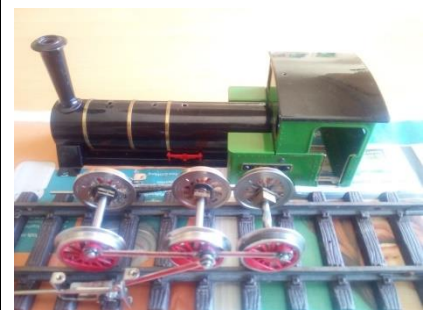
Aus der Werkstatt: Der Zusammenbau der Lokomotive T3
